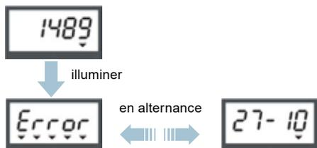
De plus, en illuminant l'afficheur après le segment test, le code Erreur s'affiche en alternance avec la date de la panne (format : JJ-MMà).
