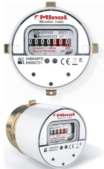
Übertragungsstandard LoRaWAN®. Das System ist offen. Es erlaubt die Einbindung weiterer Sensoren und intelligenter Anwendungen, die Liegenschaften in ein smartes Zuhause verwandeln.
