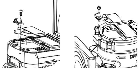
3. Coloque el acoplador NDC del módulo NDC LoRa o del módulo NDC wM-Bus en la interfaz NFC del medidor y apriételo con cuidado con el tornillo de bloqueo, evitar apretar demasiado el tornillo.
