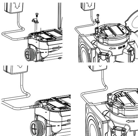
4. Fastgør NDC LoRa / wM-Bus-modulet på det ønskede installationssted - afhængigt af omstændighederne - enten ved hjælp af vægbeslaget eller ved hjælp af kabelbindere. Fastgør det tre eller ti meter lange tilslutningskabel, så der ikke er risiko for skader.
