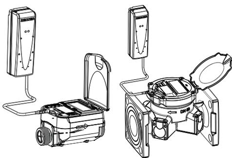
5. Sørg om muligt for, at ingen metaliske genstande blokerer for NDC-modulets radiostråling.
