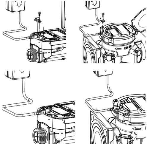
4. Fije el módulo NDC LoRa o NDC wM-Bus en el punto de instalación deseado, según las condiciones locales, ya sea utilizando el soporte de pared existente o bridas para cables. Coloque el cable de conexión de tres o diez metros de longitud de forma que no exista riesgo de lesiones.
