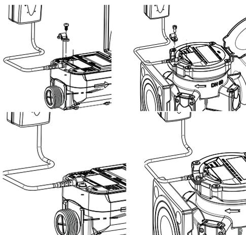
4. Fissare il modulo NDC LoRa o NDC wM-Bus al punto di installazione desiderato, a seconda delle condizioni locali, utilizzando il supporto a parete esistente o le fascette per cavi. Fissare il cavo di collegamento lungo tre o dieci metri in modo che non vi sia pericolo di lesioni
