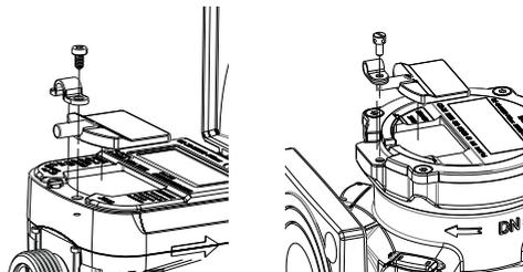
3. Placera NDC-kopplaren på NDC LoRa- eller NDC wM-bussmodulen på mätarens NFC-gränssnitt och dra försiktigt åt den med låsskruven så att skruven inte dras åt för hårt.
