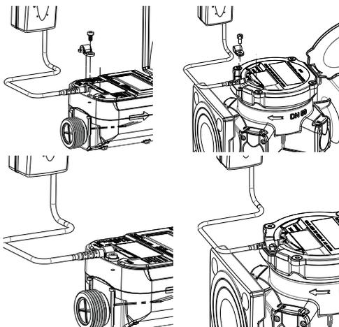
4. Fäst NDC LoRa / wM-Bus-modulen på önskad installationsplats - beroende på omständigheterna - antingen med det befintliga väggfästet eller med hjälp av buntband. Fäst den tre eller tio meter långa anslutningskabeln så att det inte finns någon risk för skador.
