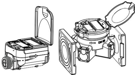
2. Das zum Schutz der NFC-Schnittstelle des Zählers ab Werk serienmäßige vorhandene NDC-Dummy-Modul vom Wasserzähler lösen. Dazu die Befestigungsschraube mit passendem Schraubendreher lösen und den Kunststoff-Dummy herausnehmen.
