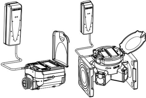
5. Cuando sea posible, asegúrese de que ningún objeto metálico impida la emisión de radio del módulo NDC.
