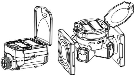
2. Libere el módulo ficticio NDC estándar de fábrica del medidor de agua que se utiliza para proteger la interfaz NFC del medidor. Para ello, afloje el tornillo de fijación con el destornillador adecuado y retire el módulo ficticio de plástico.
