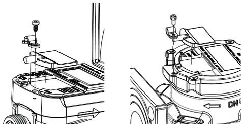
3. Sæt NDC-koblingen på NDC LoRa- eller NDC wM-Bus-modulet på målerens NFC-interface, og stram den forsigtigt med låseskruen for ikke at overspænde skruen.
