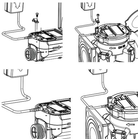
4. Fixer le module NDC LoRa / wM-Bus à l'endroit d'installation souhaité - selon les conditions - soit à l'aide du support mural existant, soit à l'aide de serre-câbles. Fixer le câble de connexion de trois ou dix mètres de long de manière à éviter tout risque de blessure.
