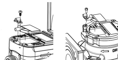
3. Posizionare l'accoppiatore NDC dell'NDC LoRa o del modulo NDC wM-Bus sull'interfaccia NFC del misuratore e serrare attentamente con la vite di bloccaggio, in modo da evitare di stringere eccessivamente la vite.
