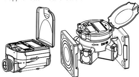
2. Ta bort den befintliga NDC-atrappmodulen från vattenmätaren som är standard för att skydda mätarens NFC-gränssnitt. För att göra detta, lossa fästskruven med en lämplig skruvmejsel och ta bort plastdockan.
