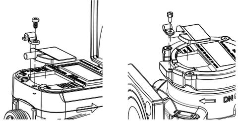
3. Den NDC-Coupler des NDC-LoRa- bzw. des NDC wM-Bus-Moduls auf die NFC-Schnittstelle des Zählers legen und mit der Sicherungsschraube vorsichtig festziehen, um die Schraube nicht zu überdrehen.
