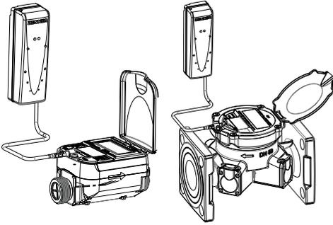
5. Attention à ce que, dans la mesure du possible, aucun objet métallique n'entrave le signal radio du module NDC.
