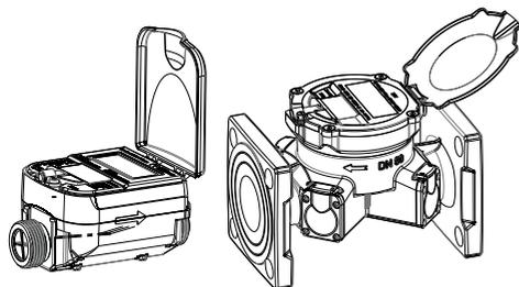
2. Rimuovere il modulo fittizio NDC esistente dal contatore dell'acqua fornito di serie per proteggere l'interfaccia NFC del contatore. A tale scopo allentare la vite di fissaggio con un cacciavite adatto e rimuovere la copertura in plastica.
