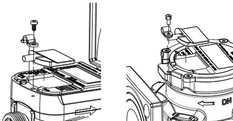
3. Placer le coupleur NDC du module NDC-LoRa ou du module NDC wM-Bus sur l'interface NFC du compteur et le serrer avec précaution à l'aide de la vis de sécurité afin de ne forcer la vis.
