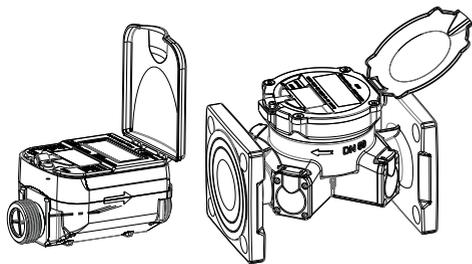
2. Fjern standard NDC-dummy-modulet fra vandmåleren for at beskytte målerens NFC-interface. For at gøre dette skal du løse fastgørelsesskruen med en passende skruetrækker og fjerne plastdummyen.
