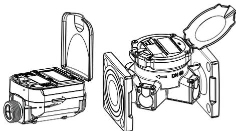
2. Détacher du compteur d'eau le module factice NDC présent de série pour protéger l'interface NFC du compteur. Pour cela, desserrer la vis de fixation à l'aide d'un tournevis adapté et retirer le module factice en plastique.
