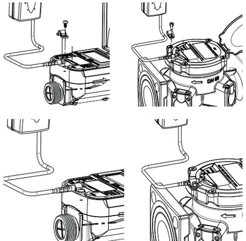
4. Das NDC LoRa / wM-Bus-Modul am gewünschten Installationsort – je nach Gegebenheiten – entweder mittels der vorhandenen Wandhalterung oder mittels Kabelbindern befestigen. Das drei bzw. zehn Meter lange Verbindungskabel so befestigen, dass keine Verletzungsgefahr besteht.
