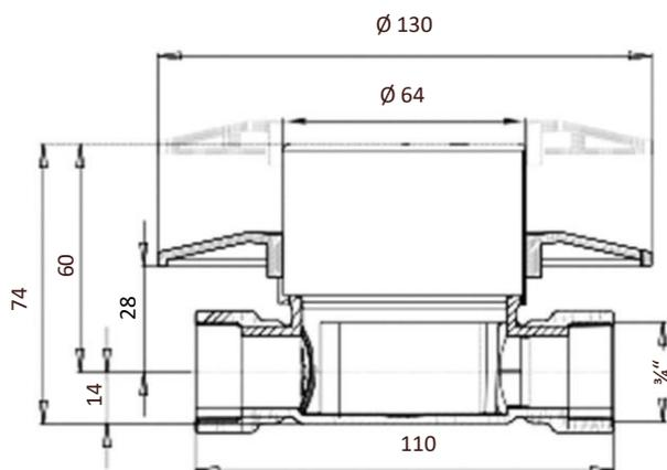
Il nuovo Kit Circle contatore da incasso per misurare il consumo di acqua calda e fredda è caratterizzato da elevata affidabilità di misurazione e facilità di manutenzione. Il compatto contatore a capsula può essere facilmente inserito nella robusta interfaccia di connessione in ottone e fissato con un anello di bloccaggio. In qualsiasi momento.
