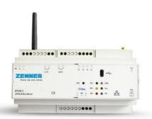
Concentratore dati per contabilizzatori con modem per la trasmissione delle letture via e- mail oppure ad un Server WEB, con tele-allarmistica e tele-controllo tramite SMS. Installazione su guida DIN da 9 moduli per i modelli da 30 e 60 unità e da 18 moduli con espansione per i modelli da 120 e 250 unità
